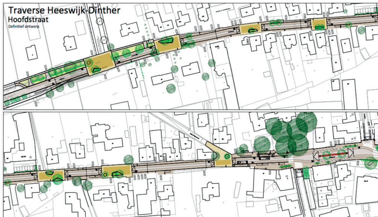
Afbeelding herinrichting Fase 2. Loopt vanaf de Abdijstraat tot ongeveer de komgrens Heeswijk-Dinther. Ook wordt een regenwaterriool aangelegd van de Gouverneursweg tot de Veldstraat.
