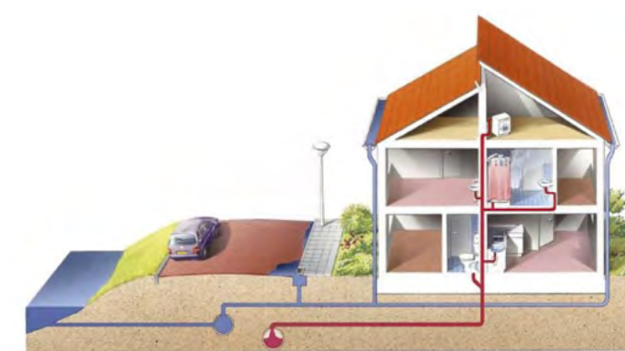
Een gemengd rioolstelsel
